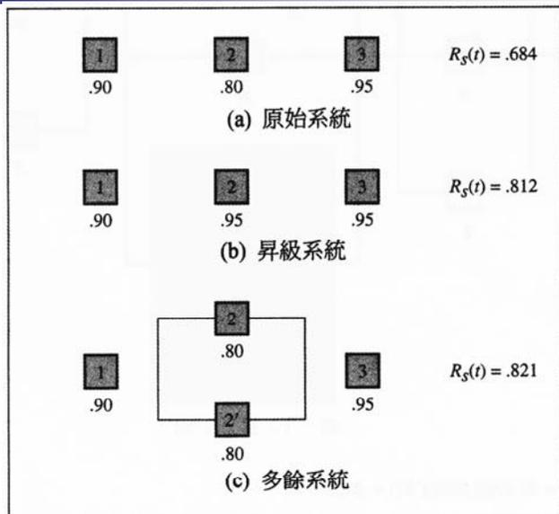
圖 6-9 兩種增加系統可靠度方式的示意圖
